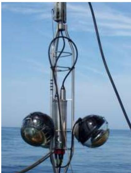
*Abbildung 1.14: Ein ANTARES Stockwerk kurz bevor es ins Wasser gelassen wird. Zu sehen sind die zwei runden Optischen Module, das dritte ist hinter dem linken Optischen Modul verborgen. LCM und das elektrooptische Kabel sind auch zu sehen.*
