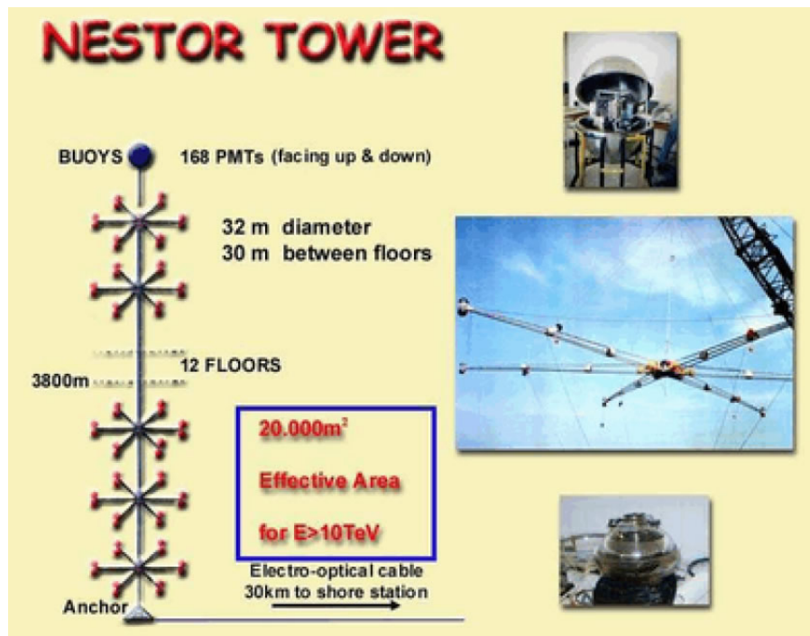
Fig. II.37 – Structure d'une tour Nestor.
