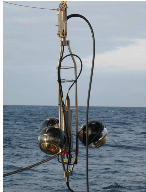
FIG. (II) 3.14: Photographie d'un étage standard sur le point d'être immergé [img16].
