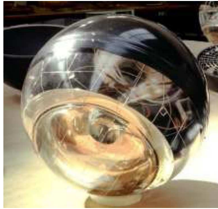
FIG. 2.16: Photographie d'un module optique utilisé sur le télescope ANTARES.
