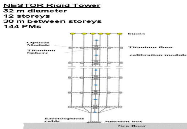
FIG. 2.11: Configuration d'une tour rigide du télescope à neutrinos NESTOR.
