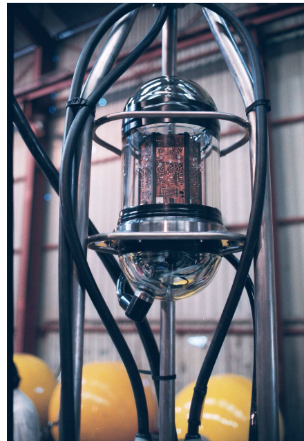
Figure A.41 : Balise LED installée au sommet d'un étage [44]. L'image complète de l'étage est visible sur la Figure A.32.
