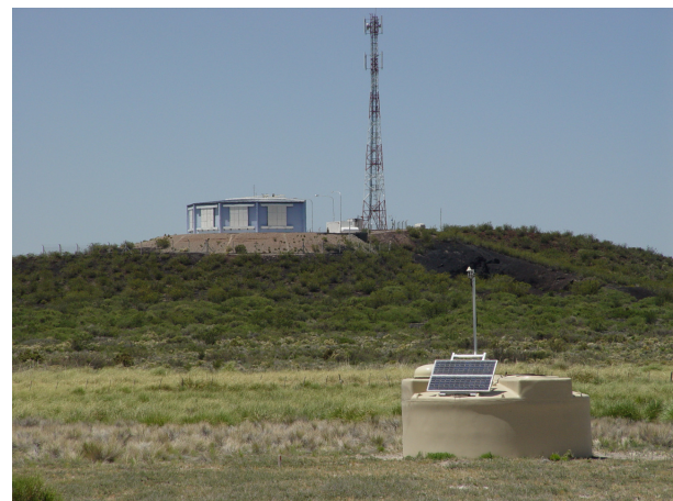
Figure C.16 : Un détecteur de fluorescence d'AUGER, avec - en bas - une cuve d'eau exploitant l'effet Tcherenkov.
