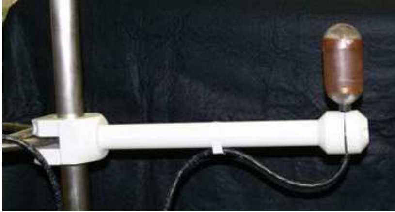
Figure A.48 : Un hydrophone pour la détection acoustique des neutrinos, installé sur la ligne instrumentée [39].
