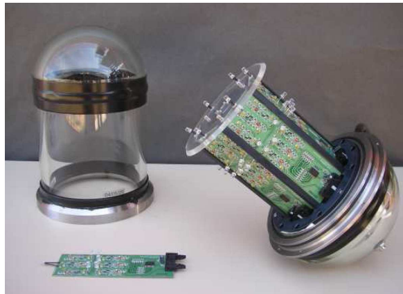
FIG. 2.14 – Image d’une LED beacon utilisée dans la calibration en temps du détecteur ANTARES. Trois des six faces hexagonales, contenant les LED, sont visibles, ainsi que le conteneur en verre, servant à protéger le dispositif.
