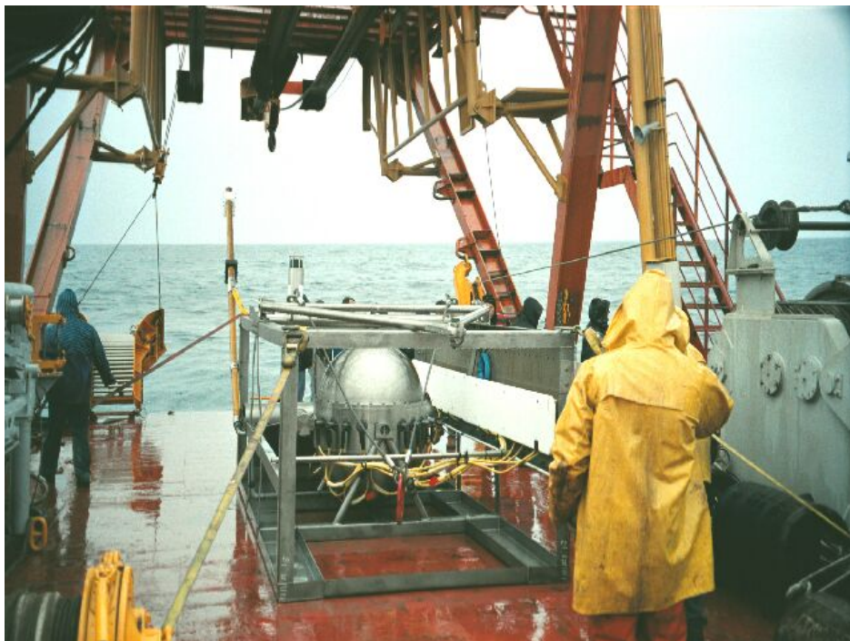
Figure B-19 : photographie montrant la boîte de jonction sur le bateau peu de temps avant sa mise à l'eau.
