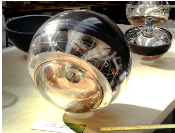
FIG. 2.7 – Photo d'un module optique. A l'intérieur, on distingue le photomultiplicateur. On voit aussi la partie de la sphère peinte en noir afin d'éliminer un trop important taux de comptage de muons descendants. En arrière plan, on aperçoit la cage en mu-métal qui protège les photomultiplicateurs du champ magnétique terrestre.
